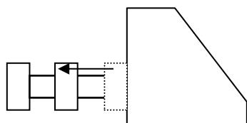
2. Loosen and remove torsion bolt.
